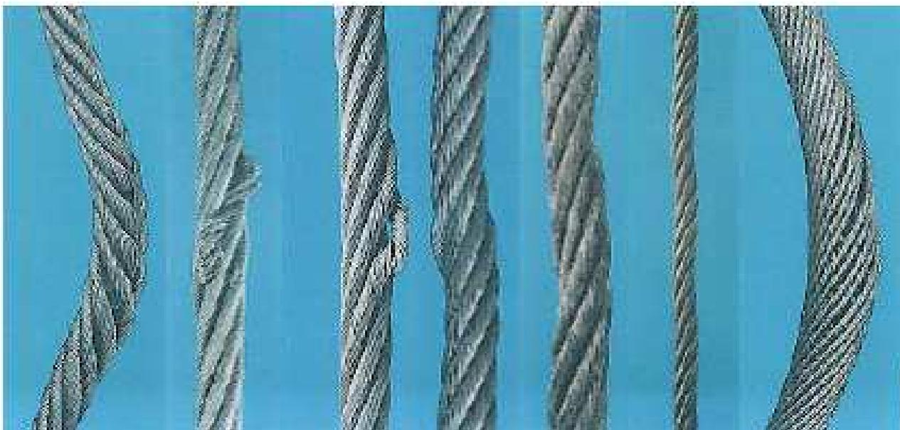
**Câble d'acier lâche, tordu, écrasé, en cage d'oiseau, déformé en tire-bouchon ou tout dommage entraînant la déformation de la structure du câble.**
